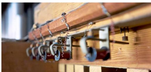
Elektromechanische Ventilsteuerung in der Opus 1052.
