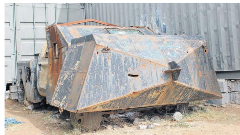
Selbstmord-Attentäter des IS fahren mit diesen gepanzerten Fahrzeugen in die Stellungen verfeindeter Streitkräfte. Die Ladefläche ist mit Sprengstoff befüllt, der durch die Wucht des Aufpralls als Feuerbombe nach vorne katapultiert wird.
