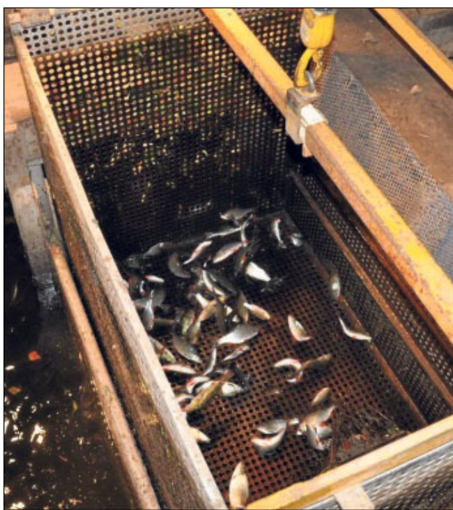
Am Wasserkraftwerk in Banteln werden die Fische in Körben gesammelt, gezählt und wieder ausgesetzt.
