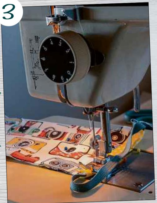
Mit dem Schrägband die Kanten einfassen. Bilder: Nüßle
